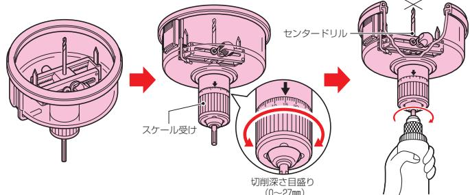
①フレームを移動させ径を調整します。
