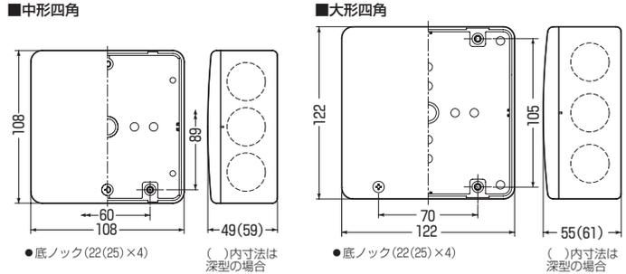
●底ノック(22(25)×4) ( )内寸法は深型の場合 ●底ノック(22(25)×4) ( )内寸法は浅型の場合
