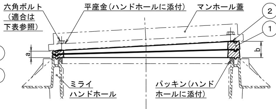
施工状態参考図 (製品2枚重ね時)
